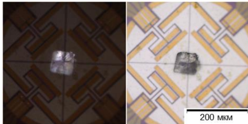
Рисунок 8П – Изображения, полученные с помощью оптической микроскопии, в поляризованном и отраженном свете при комнатной температуре исходной формы 1В , который был использован для получения формы 1А нагревом до 200 °С и охлаждением до комнатной температуры со скоростью нагрева/охлаждения 10 К/с. Изображения, полученной таким образом, образца формы 1А показаны на рисунке 9б.
